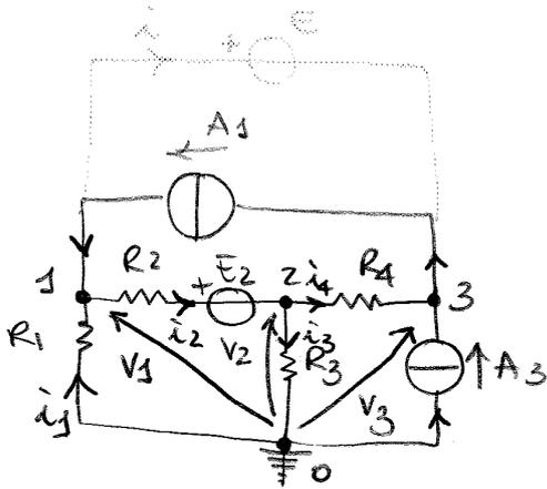
Scrivere la matrice relativa al calcolo delle tensioni  $V_1, V_2$  e  $V_3$  mediante metodo dei potenziali ai nodi (solo rete in nero) e metodo dei potenziali ai nodi modificato (incluso parte blu)
