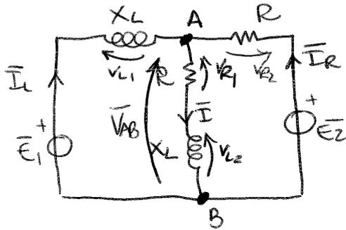
Calcolare le correnti  $\bar{I}$ ,  $\bar{I}_R$  e  $\bar{I}_L$  e disegnare il diagramma fasoriale
