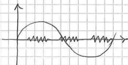
La componente a 5000 Hz è un disturbo e non deve essere misurata. si può progettare un filtro che abbatta in parte il rumore e lasci passare in parte il segnale a 50 Hz.
