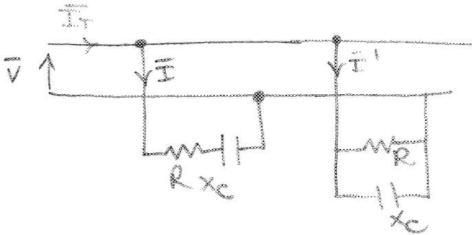
Calcolare il valore della corrente assorbita dal carico serie, dal carico // e il valore della corrente totale.
