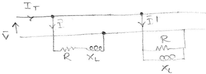
calcolare il valore della corrente assorbita dal carico serie, dal carico parallelo ed il valore della corrente totale.
