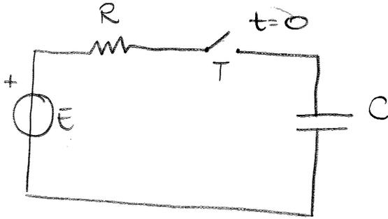
Il TASTO T si chiude in  $t=0s$  con il condensatore scarico
