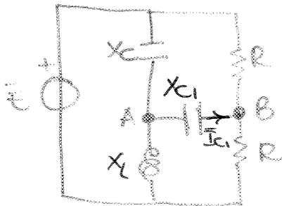
Calcolare corrente che circola nella capacità C1 e disegnare diagr. fasoriale delle principali grandezze della rete.
