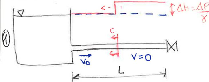
DOPO LA CHIUSURA SI CREA UN'ONDA DI PRESSIONE CHE SI PROPAGA ALL'INTERNO DELLA CONDOTTA FINO A RAGGIUNGERE IL SERBATOIO.
