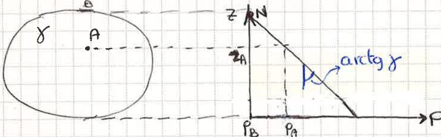
PER TRACCIARE IL GRAFICO È NECESSARIO CONOSCERE ALMENO LA PRESSIONE IN UN PUNTO (A). PER UN PUNTO PASSANO INFINITE
