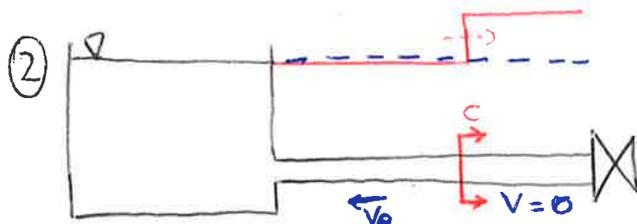
L'ONDA DI PRESSIONE NON HA ENERGIA SUFFICIENTE PER MODIFICARE IL LIVELLO DEL SERBATOIO. IL LIVELLO DEL SERBATOIO FISSA IL CARICO E LA NON COMPATIBILITÀ TRA LA SITUAZIONE NELLA CONDOTTA E QUELLA NEL SERBATOIO GENERA
