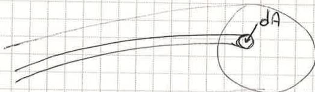
$v dA = dQ$  ← VOLUME DI FLUIDO CHE LA CORRENTE FA PASSARE IN  $dA$  NELL'UNITÀ DI TEMPO
