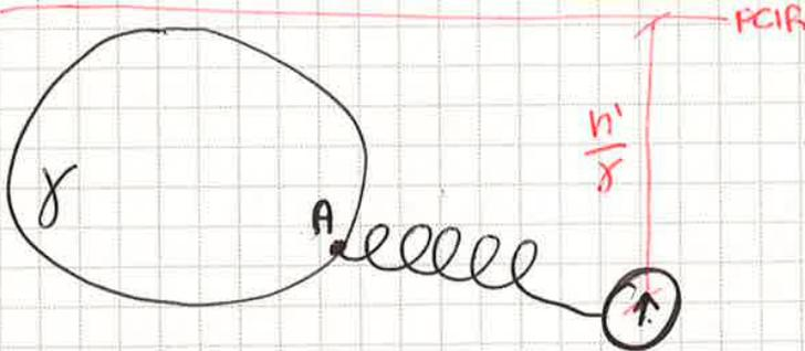
IL MANOMETRO È COLLEGATO AL SERBATOIO MEDIANTE UN TUBICINO CHE A SUA VOLTA È COLLEGATO A UN QUADRANTE. IL FLUIDO PENETRA NEL TUBICINO E PREME SU UN SISTEMA DI LEVETTE CHE FA RUOTARE LA LANCETTA DEL QUADRANTE.
