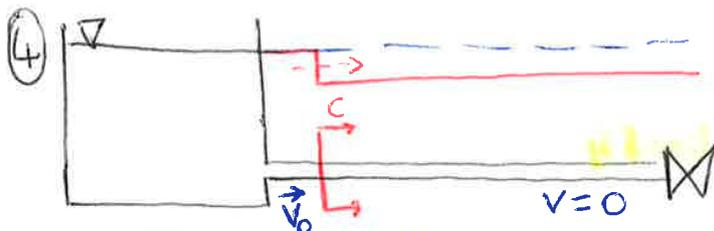
AL TERMINE DELLA TERZA FASE SI HA UNA SITUAZIONE DI PRESSIONE RIBASSATA OVUNQUE RISPETTO ALLA CONDIZIONE INIZIALE CHE DI NUOVO NON È COMPATIBILE CON QUELLA DEL SERBATOIO E NASCE QUINDI UN'ALTRA ONDA
