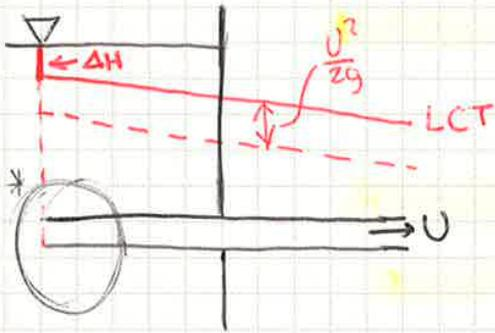
LA CONDOTTA VA A PESCARE ALL'INTERNO DEL SERBATOIO STESSO.
