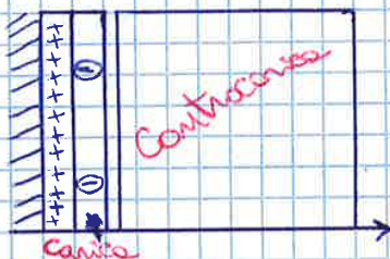
Strato aderente alla superficie del solido ( 0,1 - 0,2 \text{ nm} )
