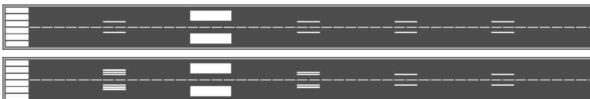
FIGURA 1.2 – Pista con punto di mira (il rettangolo bianco grosso) e distanze prima non e poi codificate
