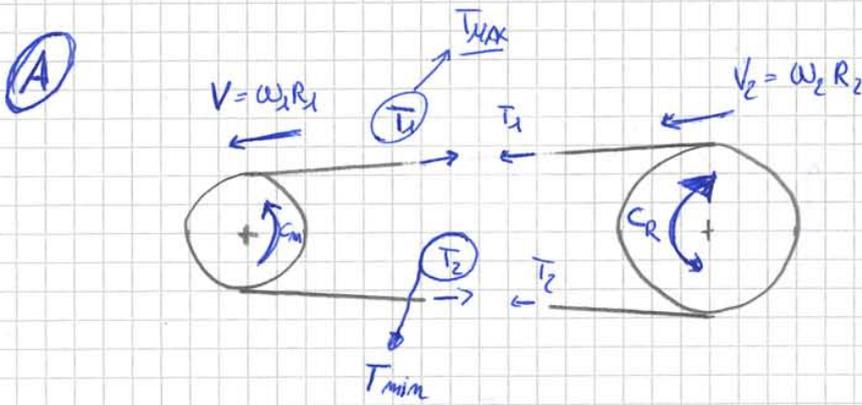
$$\begin{cases} C_m + T_2 R_1 = T_1 R_1 \\ C_R + T_2 R_2 = T_1 R_2 \end{cases} \Rightarrow \begin{cases} C_m = R_1 (T_1 - T_2) \\ C_R = R_2 (T_1 - T_2) \end{cases}$$
