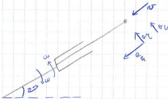
$$\vec{a} = \omega^2 \cdot b + \dot{\omega} \cdot b + 2\omega v_{\text{rel}}$$
