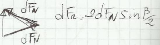
x le cinghie dentate e la  $F_N$  che determina la trasmissione
