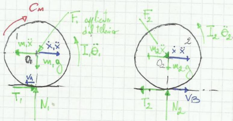
$$\rightarrow T_1 - T_2 - M\ddot{x} = 0$$
