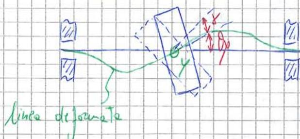
Lo squilibrio dinamico  $\gamma$  impedisce al disco di ruotare attorno al suo asse polare.
