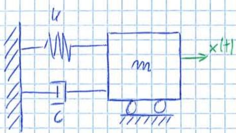
Si considera un sistema a un grado di libertà (1DOF), la massa  $m$  è vincolata a traslare orizzontalmente e sono ad essa collegate una molla di rigidezza  $k$  e uno smorzatore viscoso con costante  $c$ .
