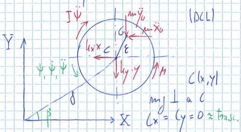
L'anisotropia può essere tipica dei cuscinetti magnetici in cui è possibile controllare la rigidezza nelle due direzioni o i cuscinetti lubrificati in cui diverse rigidezze possono essere ottenute modificando le caratteristiche del lubrificante.
