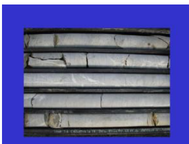
Roccia compatta. Si è frattura nell'estrazione dalla carota
