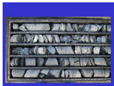
Roccia compatta. Si è frattura nell'estrazione dalla carota
