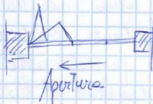
Portone flessibile a libro: chiusura mediante impacchettatura laterale del libro tramite carrelli di scorrimento e cilindri pneumatici. Chiusura robusta
