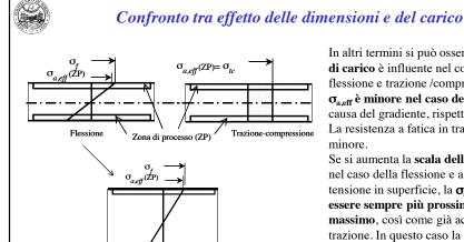
In altri termini si può osservare che il tipo di carico è influente nel confronto tra flessione e trazione /compressione perché la  $\sigma_{a,eff}$  è minore nel caso della flessione a causa del gradiente, rispetto alla trazione. La resistenza a fatica in trazione è dunque minore.
