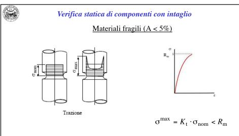
Attenzione: nei materiali fragili per la verifica statica è necessario moltiplicare la tensione nominale per il fattore  $K_t$  in quanto anche solo la generazione di una cricca in quel punto è letale per il componente.
