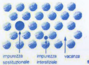
(a) Principali difetti di un reticolo metallico. (b) Rappresentazione schematica di una dislocazione in un reticolo cristallino.
