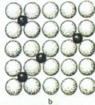
(a) Rappresentazione schematica di una soluzione solida per sostituzione (b) Rappresentazione schematica di una soluzione solida per intrusione.
