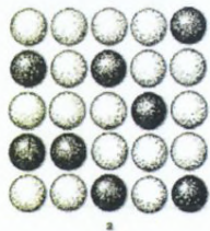
(a) Rappresentazione schematica di una soluzione solida per sostituzione (b) Rappresentazione schematica di una soluzione solida per intrusione.
