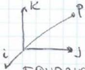
Ogni punto dello spazio può essere identificato da 3 coordinate.  $\vec{r}$  sarà il vettore posizione che identifica il punto e che si compone dalla somma delle tre coordinate rettonali. ES  $\vec{r}(t) = x(t)\mathbf{i} + y(t)\mathbf{j} + z(t)\mathbf{k}$
