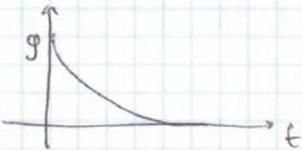
Quando l'accelerazione giunge a zero il corpo si muove con velocità limite
