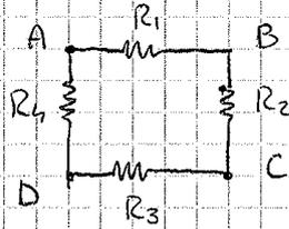
$$R_{eq}(AC) = (R_1 + R_2) // (R_3 + R_4)$$
