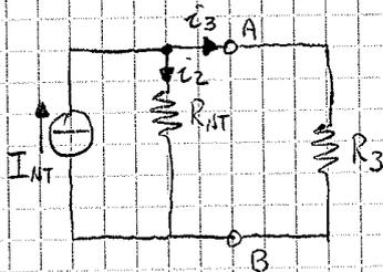
La corrente  $I_{NT}$  del generatore ideale si ripartisce tra due resistenze e dunque posso usare la formula del partitore di corrente (con  $I_{NT}$  corrente globale) per trovare  $I_3$ :
