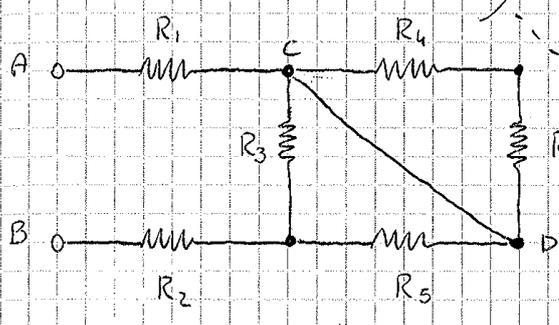
$R_4, R_6$  sono due resistenze in serie connesse tra due terminali con diff. di potenziale nullo,  $V_{CD} = 0$
