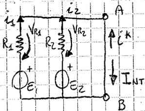
$V^* = 0$  corto circuito AB, definiamo la corrente  $i_1, i_2$  e la tensione  $V_{R1}, V_{R2}$ .
