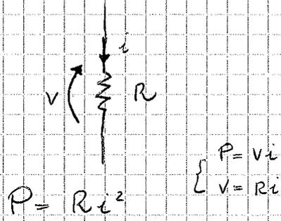
Correnti troppo elevate aumentano di un valore  $i^2$  la potenza da dissipare, cioè vuol dire che all'aumentare della corrente aumenta la quantità di calore da dissipare (perché il conduttore si scolora).
