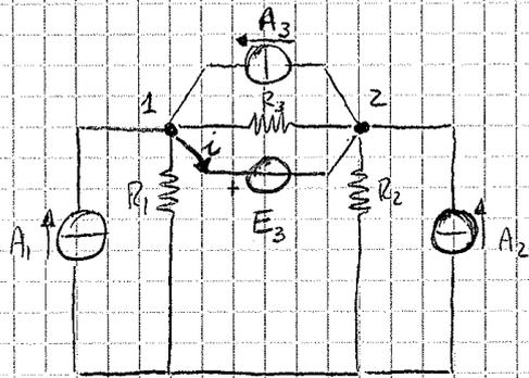
Immaginiamo di volere trasformare questo circuito nel suo equivalente NORTON trasformandolo al gen. di tensione...
