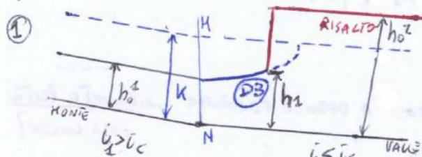
Passaggio di corrente avviene con un RISALTO o SALTO di Bidone
