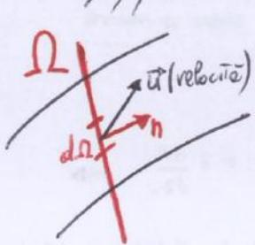
$$dQ = \vec{u} \cdot \vec{n} d\Omega \rightarrow \text{flusso di particelle che passano}$$
