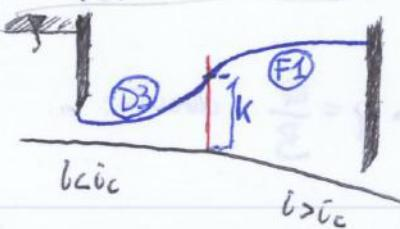
Se è di velocità a lenta nel recalo fatto con una forte pendenza l'unico profilo è  $F_1$  in a monte ha lo stato critico ed a valle lo stato uniforme.
