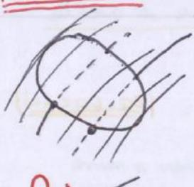
Dietro il tubo di flusso c'è il concetto di PENETRABILITÀ (quindi non hanno una componente normale alle linee di corrente) → quindi le particelle passano attraverso il tubo di flusso.
