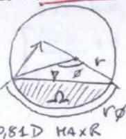
$(\phi)$  è un TRASSIZZO del Raggio idraulico  $R_{MAX} = \frac{1}{2} r \cdot P = r \phi$
