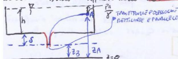
a prima sezione trasversale della corrente dove questo avviene  $\rightarrow$  SEZIONE CONTRATA  $\rightarrow$  come ha area inferiore a quella della luce
