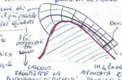
le linee EQUIPOVENTIALI e le linee di corrente sono perpendicolari fra loro.  $q_1, q_2, q_3, q_4$  sono le portate e  $1/U$  del rapporto
