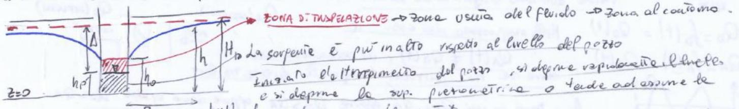
Si ha un livello ( $h_p$ ) più basso di  $h_0$  in cui c'è una fonte di infiltrazione del pozzo fra i livelli  $h_0$  e  $h$  dove il liquido sbocca dalle falde nell'atmosfera. (sup. infiltrazione)
