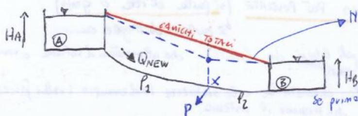
Nuova piezometrica: abbassa → si abbassa la portata  $Q_{\text{NEW}}$  perché esce  $Q-P$  il fluido.
