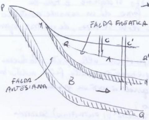
$\rightarrow$  Falda freatica e falda artesiana al di sotto dello strato piano composto che costituisce il letto delle palee freatiche e il tetto della artesiana. La curvatura può essere ascendente o discendente della superficie P.R. dove affiora la formazione permeabile.
