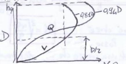
$\rightarrow$  SEZIONE VAI IN PRESSIONE FLUSSO DIVENTA UN TAPPO E LA CAVIA STAGNA, QUANDO IL TAPPO DA  $\frac{\sin \phi}{\phi}$  (NON POSSO TENERE L'ACQUA)
