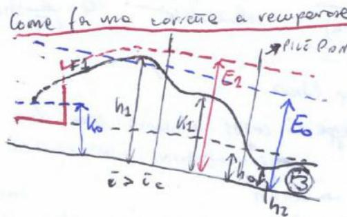
→ solo aumentando la velocità a volte (ancora più veloce) cioè abbasso il mio livello ed avrò una  $h_2$  compatibile alle chiusure → PROFILO T3 ed a monte avrò una corrente lenta ma se tolle c'era una corrente veloce ⇒ RISALTO (F1) PROFILO PRIMA dell'obstacolo
