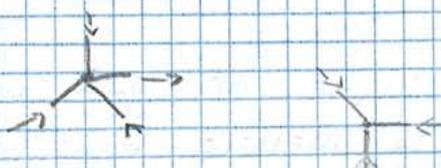
in alto o più in basso. Questo mi cambierà il quantitativo dell'armatura. Attenzione all'ancoraggio. L'armatura va sempre ancorata. L'ancoraggio dell'armatura avviene subito dopo il nodo, se non riesco per lo spazio, uso delle piastre di ancoraggio. È una limitazione da dover considerare.
