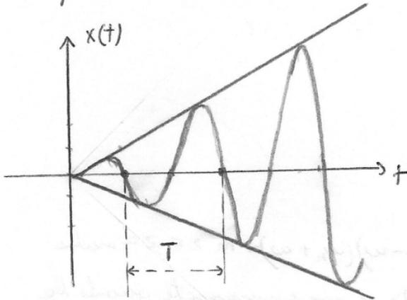
Consideriamo che se lo smorzamento è nullo e siamo nelle condizioni di risonanza  $\omega = \omega_n$  nel diagramma di Bode si osserva un comportamento anomalo dove l'ampiezza è infinita e la fase è indeterminata (o di 90° facendo un'estensione).
