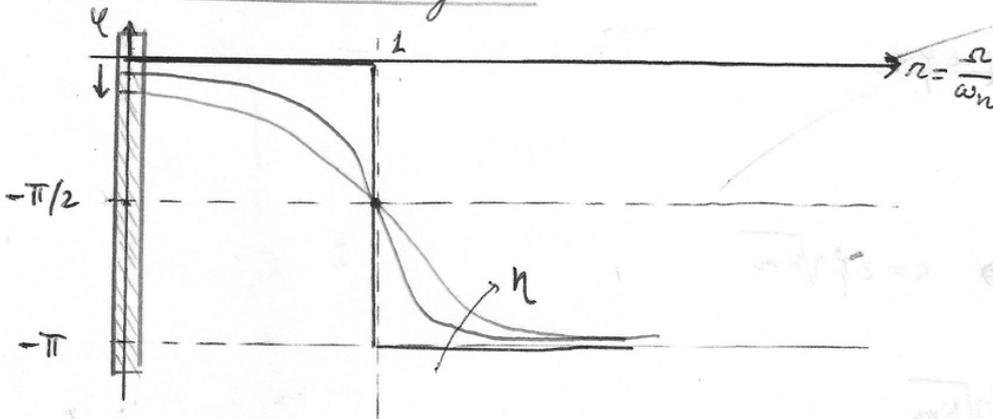
In assenza di smorzamento  $\eta = 0$  la fase va da zero a  $-\pi$  istantaneamente nel punto  $r = \omega_n$ .
