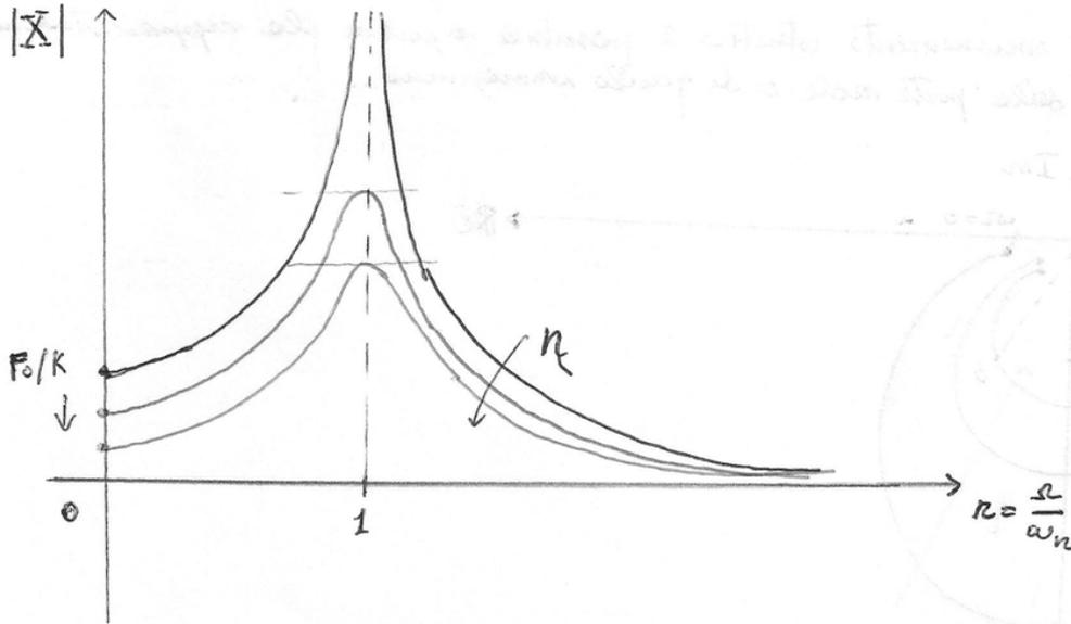
Se  $\eta = 0$  non si ha smorzamento, quindi si ha il classico andamento in parte dello spostamento statico  $F_0/K$  si va ad infinito per  $r = \omega_n$  e si va pari a zero per  $r \gg 1$ .
