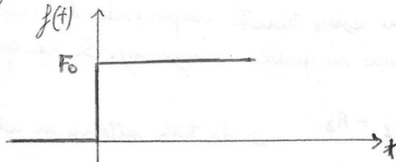
L'applicazione della forzante costante viene utilizzata nei test di creep. L'equazione di equilibrio della massa è per  $t \geq 0$  del tipo:
