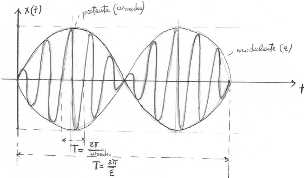
Quindi nel battimento si ha un'armonica di ampiezza elevata ( $\epsilon$  è denominatore) che pulsazione è detta portante, ampiezza però modulata da una seconda armonica di pulsazione  $\epsilon$  detta modulante. Il battimento è il risultato della somma di due armoniche con frequenze vicine.
