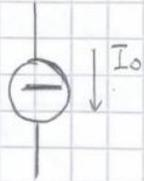
Generatore di corrente usato in un dispositivo elettronico.
