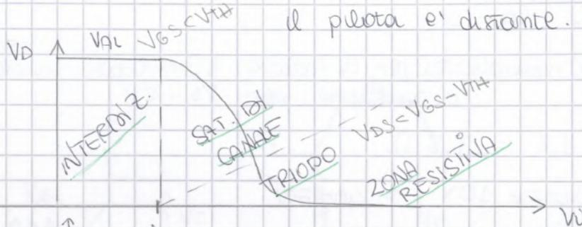
Se  $V_i < V_{TH}$  c.a.
