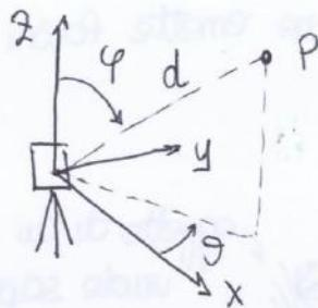
Tecnica di telelivellamento che permette di determinare la distanza  $d$ .
