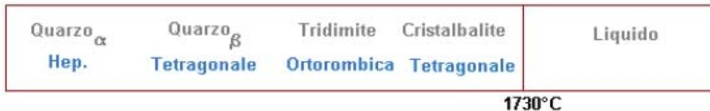
Se il nome del materiale è seguito da una lettera greca ( $Ti_{\alpha}$ ,  $Ti_{\beta}$ ) significa che la trasformazione è reversibile. Se il materiale cambia nome (tridimite, cristalbalite) significa che la trasformazione è irreversibile.
