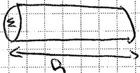
Applico legge di Ohm a conduttore cilindrico
