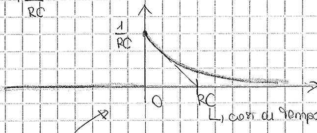
$h(t)$  è causale  $\Rightarrow$  possiamo usare il filtro RC in real-time processing.
