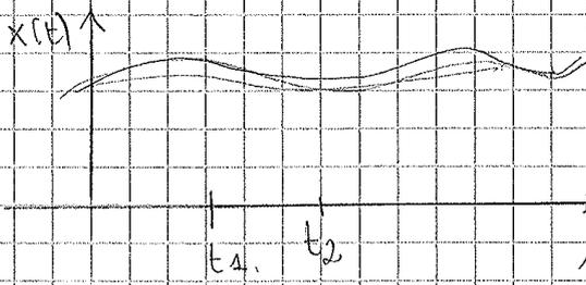
$$R(t_1, t_2) = E[x(t_1)x^*(t_2)]$$
