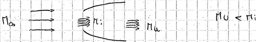
ma  $M_i$  è il Mach di volo? no! perché in campo subsonico la particella sente la presenza dell'area molto prima del suo arrivo e accelera già precedentemente al suo passaggio
