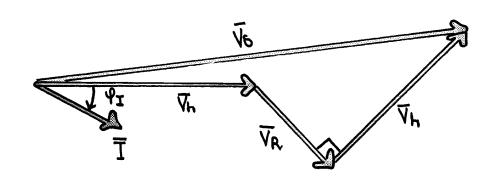
M.B. particulari combinazioni di carichi possono dere 110000 a SITUA 240NI PERICOLOGE, come, ed es., il caso di Carico capacitivo a FINE LINEA de crea TENSIONI sul Carico superiori a quelle del GENERATORE.
