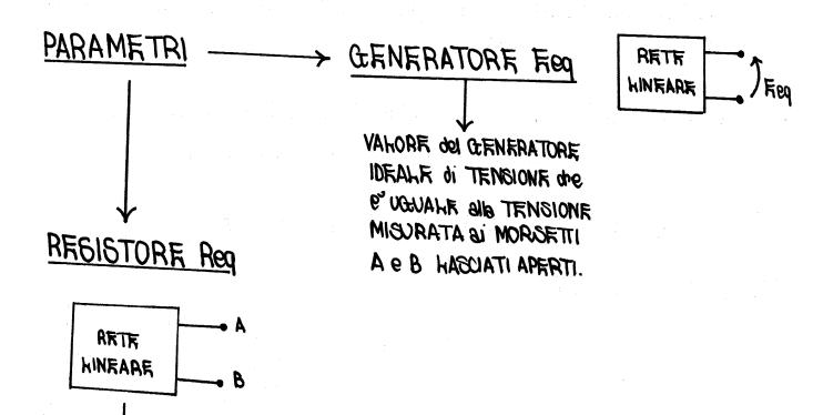
VALORE DUID RESISTENZA EQUIVALENTE MISURDEO DI MORSETTI A E B DEID RETE LINEARE CON PASSIVAZIONE DI TUTTI GENERATORI.
