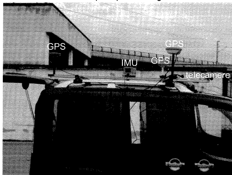
Figura 34 – veicolo sperimentale per rilievo delle geometrie stradali, attrezzato con GNSS, IMU e telecamere
