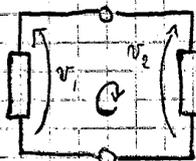
$v_1 - v_2 = 0$
