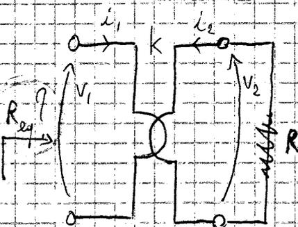
$$\begin{cases} v_1 = k v_2 \\ i_1 = -\frac{1}{k} i_2 \\ v_2 = -R i_2 \end{cases} \quad \begin{matrix} i_2 = -\frac{v_2}{R} & i_1 = \frac{v_2}{kR} \\ v_2 = -kR i_1 \\ v_1 = k v_2 = k^2 R i_1 \\ R_{eq} = \frac{v_1}{i_1} = k^2 R \end{matrix}$$
