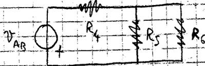
PRINCIPIO DI SOSTITUZIONE DEL GENERATORE DI TENSIONE
