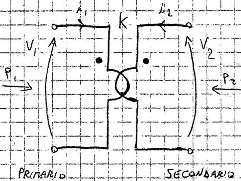
$$\begin{cases} v_1 = k v_2 \\ i_1 = -\frac{1}{k} i_2 \end{cases} \quad \begin{matrix} p(t) = v_1(t) i_1(t) + v_2(t) i_2(t) \\ p_1(t) \quad \quad \quad p_2(t) \end{matrix}$$
