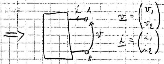
$$v_1 = (R_1 + R_2 // R_3) i_1 + (R_2 // R_3) i_2 + \frac{e(t) \cdot R_2}{R_2 + R_3}$$
