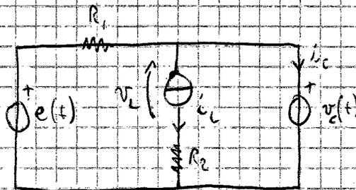
$$\begin{cases} i_C(t) = \frac{-v_C(t)}{R_1} - i_L(t) + \frac{e(t)}{R_1} \\ v_C(t) = v_C(t) - R_2 i_L(t) \end{cases}$$
