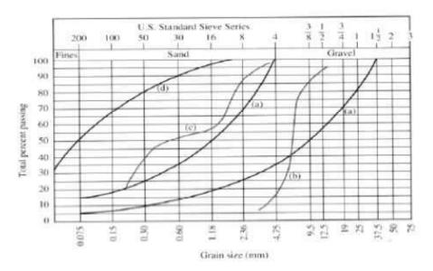
Le due curve (a) sono due curve di massima densità, ovviamente con D diverso. Le curve (b), (c) e (d) sono ottenute invece da analisi granulometriche. Dai crolli della (b) e della (c) si evince che in quei terreni mancano delle dimensioni caratteristiche, perché il passante cambia repentinamente.
