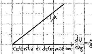
Una seconda legge semplice è espressa da una retta passante per l'origine e il cui unico parametro è il coefficiente angolare \$\mu\$, detto viscosità dinamica. I fluidi che seguono questa legge sono detti fluidi newtoniani.
