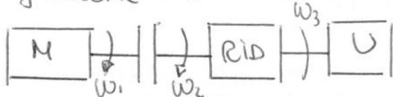
5) Motore - Volano - Utilizzatore
