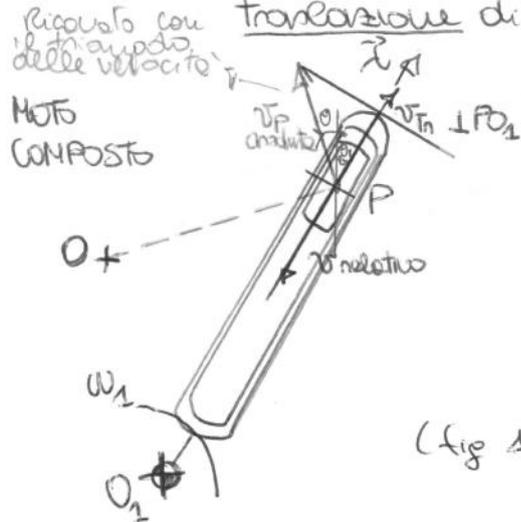
moto di trasmissione di P lungo la guida
