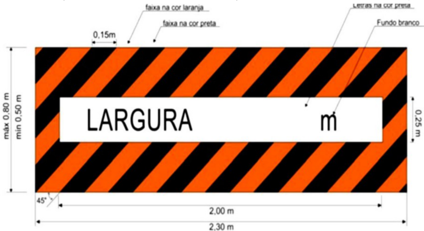
Figura 3: Sinalização especial de advertência traseira para largura excedente
