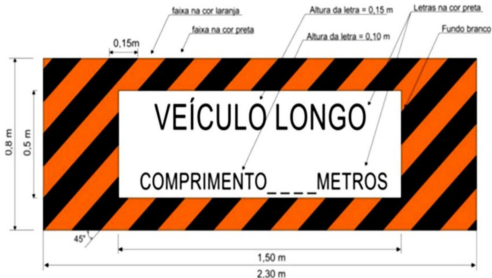
Figura 1: Sinalização especial de advertência traseira para comprimento excedente
