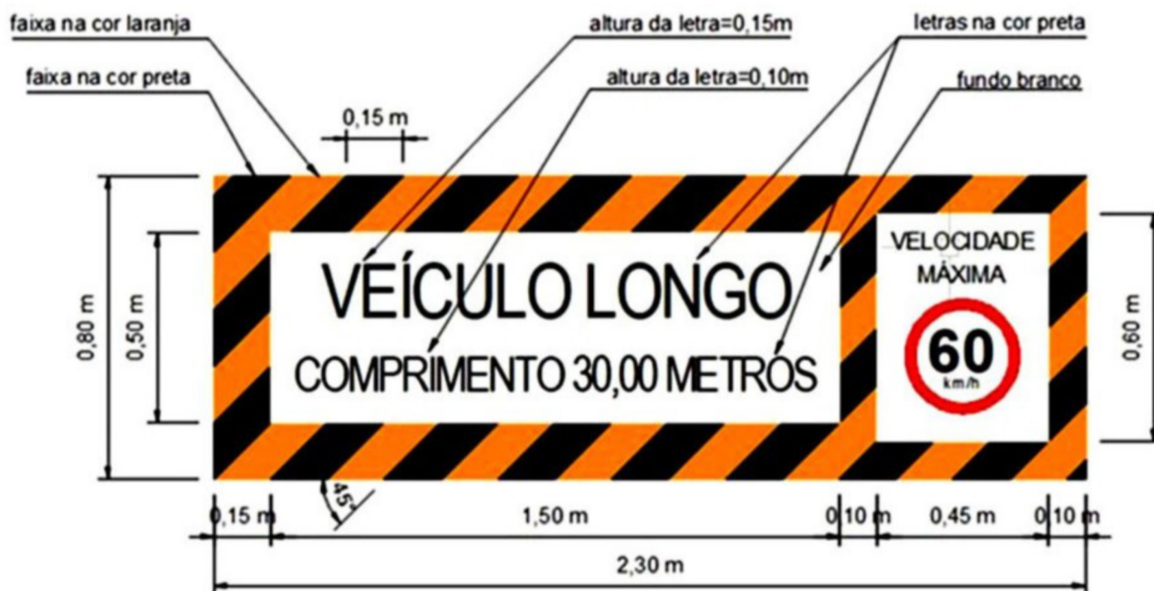
Figura 2: Sinalização especial de advertência traseira para comprimento excedente e limite de velocidade
