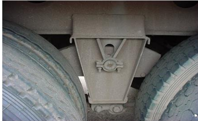
FIGURA 25 – Detalhe de uma Suspensão em Tandem
