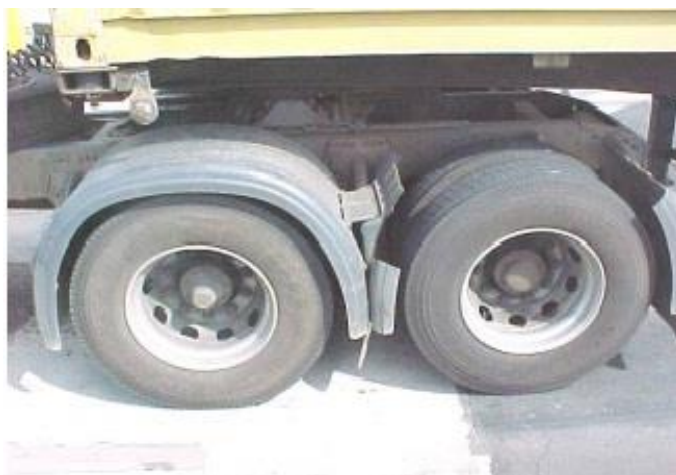
FIGURA 29 – Detalhe de uma Suspensão Não em Tandem FONTE: Koerbes, Candido, 1º TPFT/DPRF, 2010
