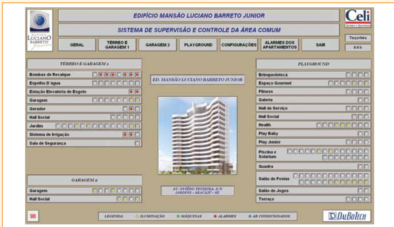
Figura 5 – Tela inicial de um sistema de supervisão e controle da área comum.
