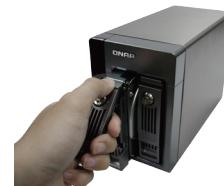
2. Insert the disk trays to the Turbo NAS and push the disk trays to the end. Schieben Sie die Laufwerkeinschübe bis zum Anschlag in den Turbo NAS ein. Insérez les plateaux de disques dans le NAS Turbo et enfoncez les plateaux de disques jusqu'au fond. Inserte las bandejas de disco en el Turbo NAS y presione las bandejas de disco hasta el final. Insira as bandejas do disco no NAS. Pressione as bandejas de disco até o final. Aperte os parafusos nas bandejas.
