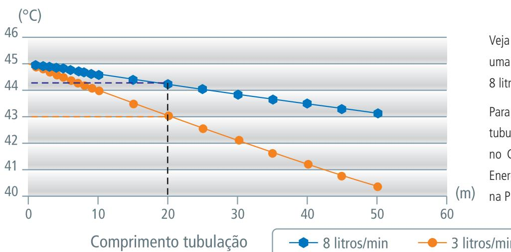
Veja no gráfico que a perda de temperatura em uma tubulação de 20 metros com uma vazão de 8 litros/minutos é de apenas 0,7 °C.
