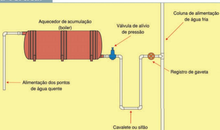
Alínea f: "a tubulação de alimentação da água fria deve ser feita com material resistente à temperatura máxima admissível da água quente".
