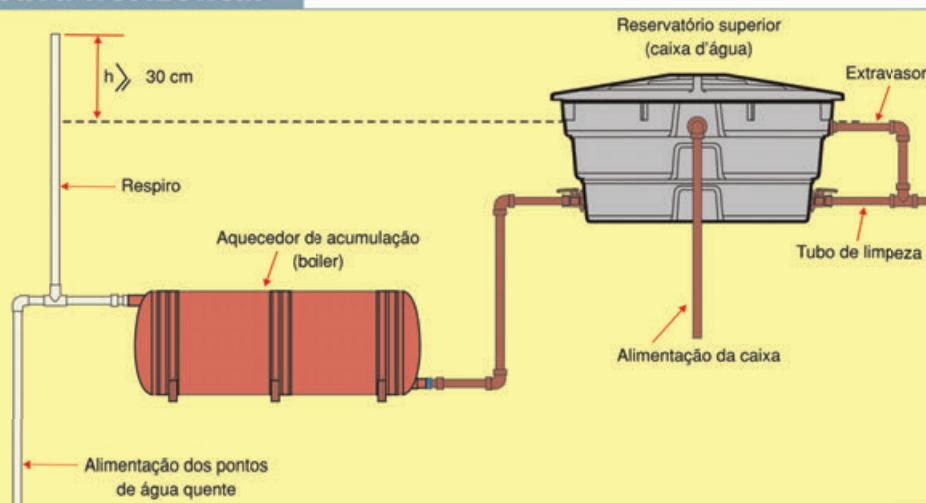
Alínea d: "quando o respiro não for de execução prática, deve ser substituído por dispositivo de idêntico desempenho".
